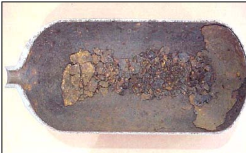
Grossflächige Korrosion einer Tauchflasche
