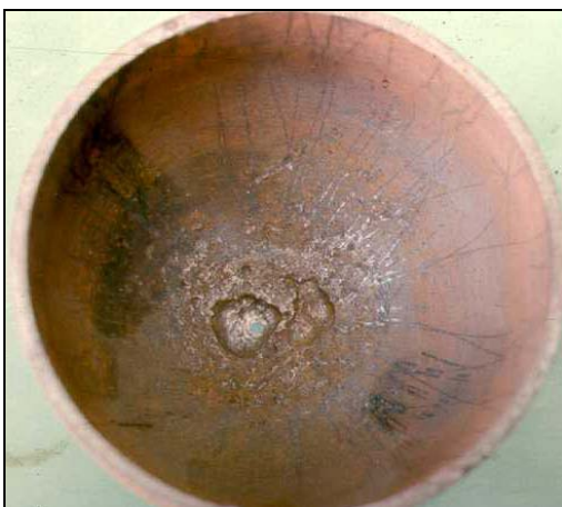
Lochfrass im Boden einer Tauchflasche
